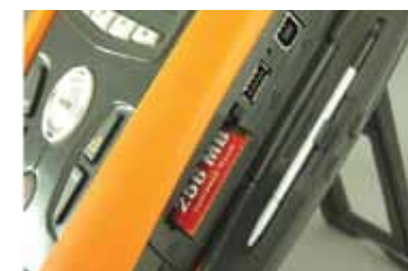
15 Mb sisäistä muistia voidaan laajentaa käyttämällä Compact Flash-muistikorttia. Myös muistitukun voi liittää mittariin.
